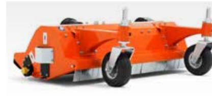
Zapfwellenbetriebener Schlagmäher. Überarbeitete Bauform mit verstärktem Kegelgetriebe, erweitertem Schnitthöhensbereich und verbesserter Leistung bei dichter Vegetation. Die schwenkbaren Front-Laufräder sind pannensicher. Arbeitsbreite 120 cm. Nur für den Einsatz mit dem P525/520 D empfohlen. Erfordert Heckgewicht.
