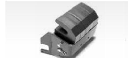
Heck-Gegengewicht für bessere Bodenhaftung und Stabilität. Muss beim Arbeiten mit frontmontierter Ausrüstung montiert werden. Gesamtgewicht: 62 kg. Umfasst 5 x 10 kg stapelbare Einzelgewichte, die auf einem Rahmen (12 kg) aufgelegt werden können.
