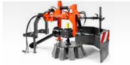
Zapfwellenbetriebener Wildkrautbesen zum gründlichen Entfernen von Unkraut und Schmutz aus Rinnen, von Gehwegen und an Bordsteinen. Der Bürstenwinkel ist vom Fahrersitz aus einstellbar. Durchmesser 50 cm. Erfordert Hydraulik-Bausatz und Gegengewicht.
